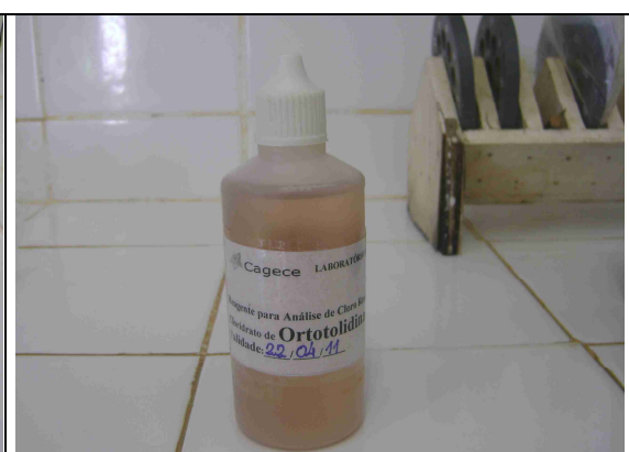
Foto 21 – Reagente químico Ortotolidina utilizado nas análises de cloro residual (dentro do prazo de validade – 22/4/2011).
