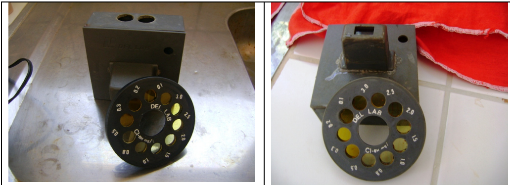
Fotos 23 e 24 – Discos de cloro com valores máximos de 3,0mg/l.
