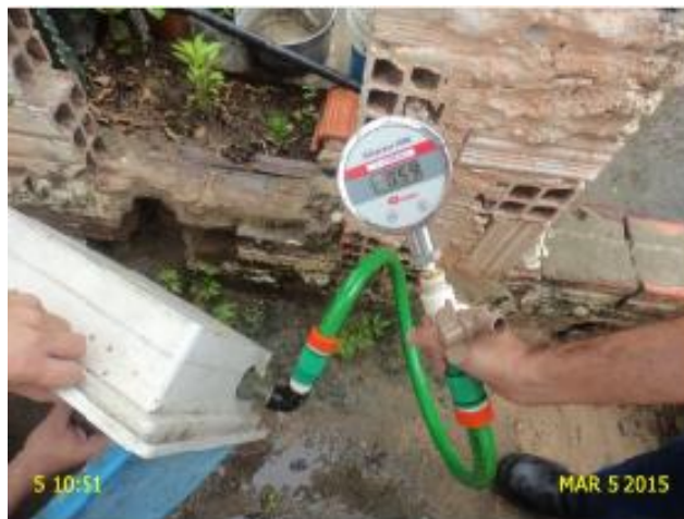
Foto 1 - RDA: Medição instantânea de pressão.
