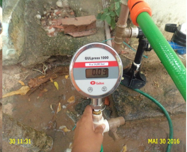
Foto 4 – RDA: Medição de pressão instantânea na rede de distribuição - Rua Chiquinha Marinheiro, SMSB 08.
