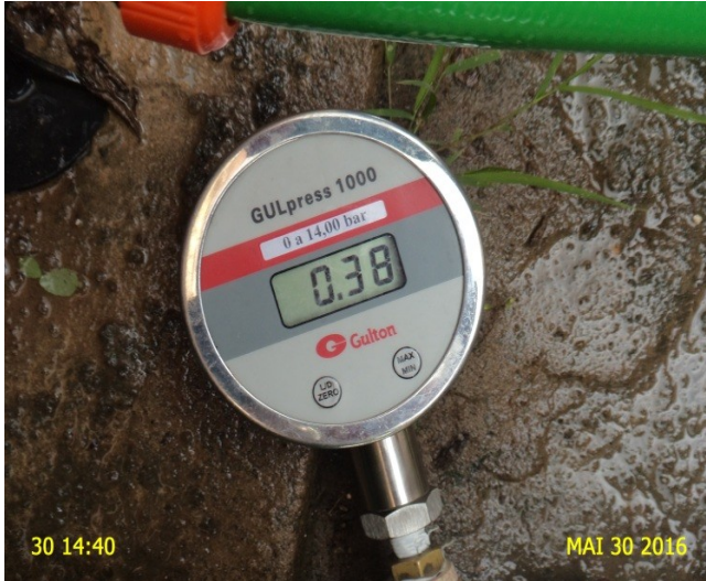
Foto 5 – RDA: Medição de pressão instantânea na rede de distribuição - Rua Félix Pereira, 183 – Centro.
