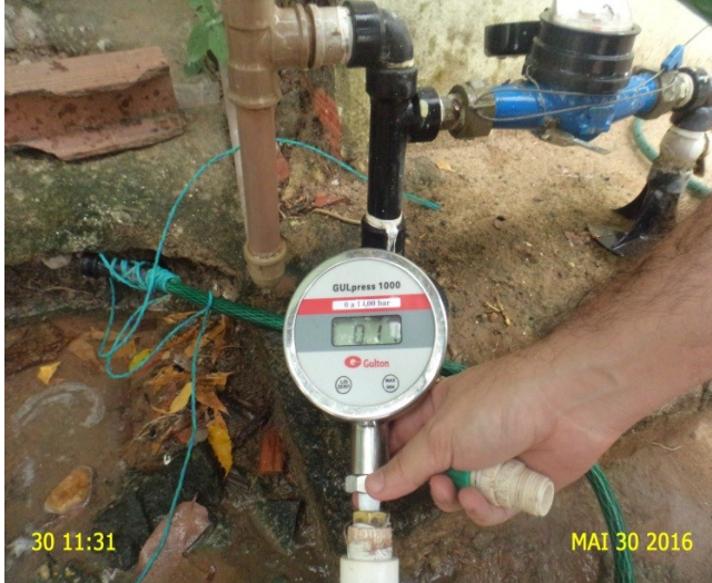
Foto 3 – RDA: Medição de pressão instantânea na rede de distribuição - Estrada para Belo Horizonte, SMSB 01.
