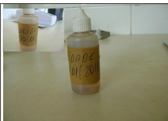
**Foto 18** – Reagente químico Ortotolidina utilizado nas análises de cloro residual, com validade vencida em 30/1/2011.
