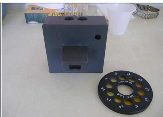
**Foto 20** – Vista do Comparador de disco colorimétrico para cloro residual.
