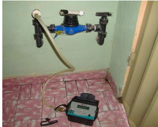
Foto 65 – Medição de pressão com instalação às 16:30h do dia 15/07/13 e retirada às 16:00h do dia 16/06/13, com aparelho datalogger na Rua Pedro Furtado de Lacerda, nº 1.114, Centro.
