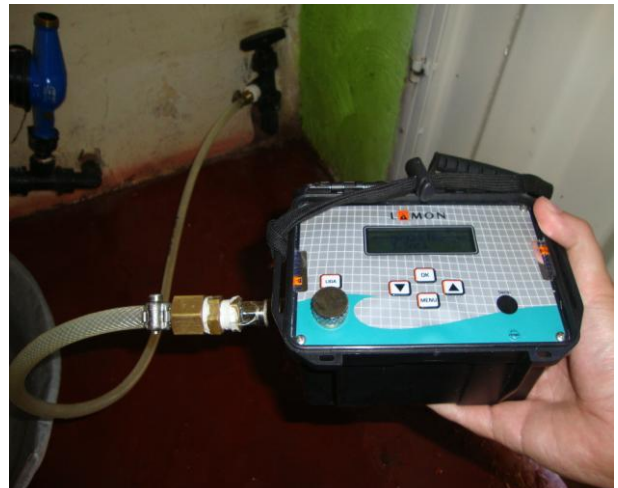
Foto 61 – Medição de pressão instantânea na Rua Bento Correia Lima, nº 50 – Frei Damião.
