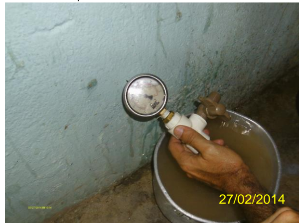
Foto 75 - Medição instantânea de pressão na rede de distribuição: Rua José Alves, 12.
