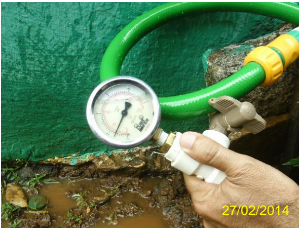
Foto 72 - Medição instantânea de pressão na rede de distribuição: Rua Sebastião Alves Pereira, 6.
