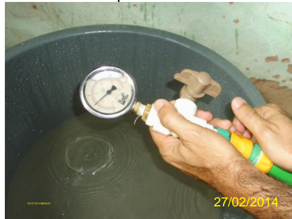
Foto 73 - Medição instantânea de pressão na rede de distribuição: Rua Vereador Vино Leite, 34.
