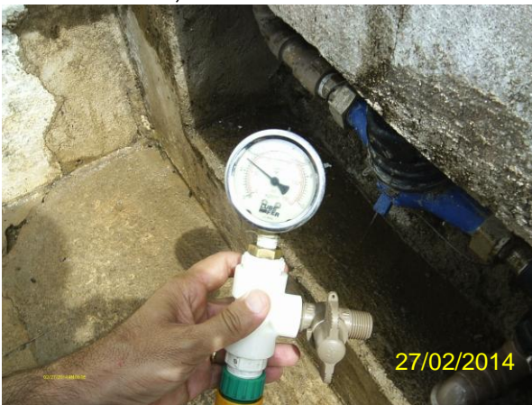
Foto 74 - Medição instantânea de pressão na rede de distribuição: Rua Guedes Martins, 184.
