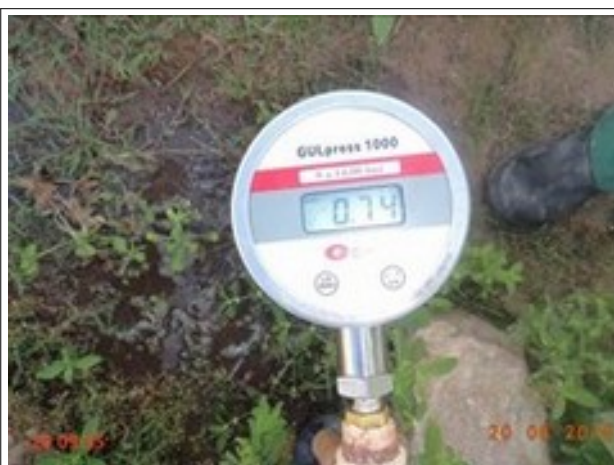
Foto 2 – RDA: medição de pressão instantânea no endereço Valência, S/N – Agência dos Correios.
