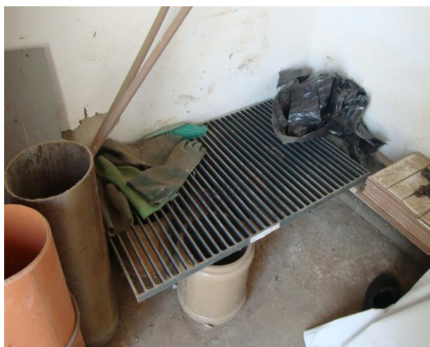
Foto 90 – Gradeamento a ser utilizado no poço de sucção e materiais.
