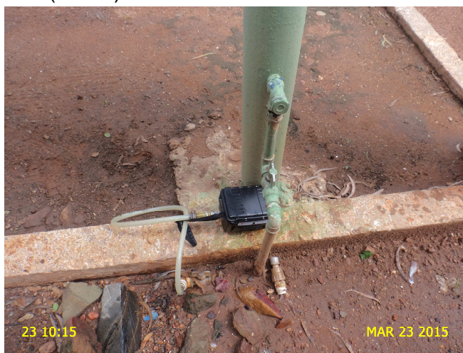
Foto 4 – Datalogger ARCE-01 - Medição contínua de pressão na Rua Colina do Horto (REL-03) – Horto.
