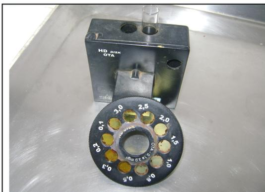
**Foto 3** – Disco de cloro com valor máximo de 3,0mg/l.
