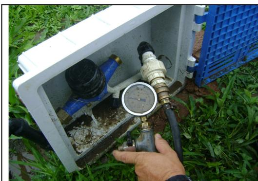
**Foto 41** – RDA: medição de pressão no endereço da Rua SDO – 27, s/n - Estação.
