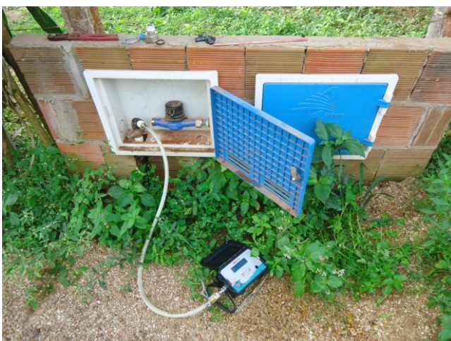
Foto 38 – Medição instantânea de pressão no Sítio Macacos, S/N.
