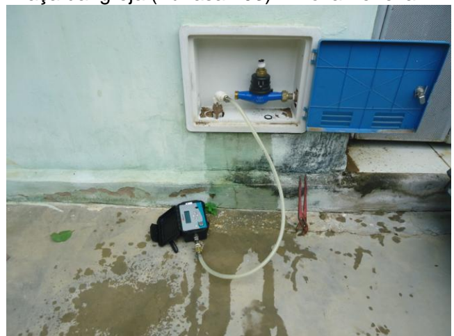
Foto 33 – Medição instantânea de pressão na Estrada para Boi Morto, S/N.
