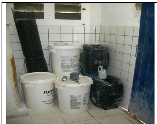
Foto 8 – Armazenamento inadequado de produtos químicos
