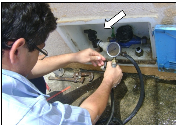
Foto 46 – Medição de pressão na Rua Oswaldo Honório Lemos, 226 – Centro, sem hidrômetro.
