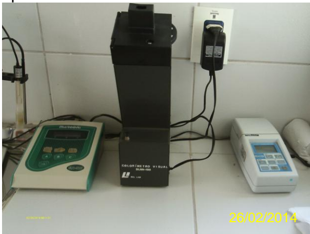
Foto 20 - ETA laboratório: equipamentos turbidímetro, pHmetro e colorímetro.
