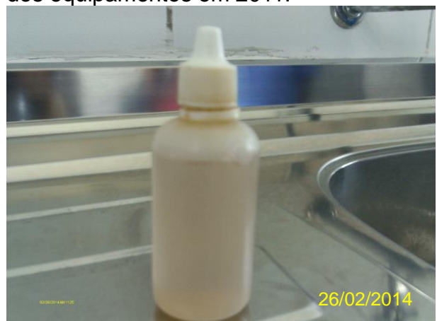
Foto 23 - ETA laboratório: reagente armazenado sem rótulo ou data de validade.
