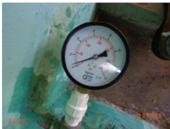
Foto 2 – RDA (Lambedouro): pressão instantânea fora da faixa de 10 a 50 mca na R. da Paz.
