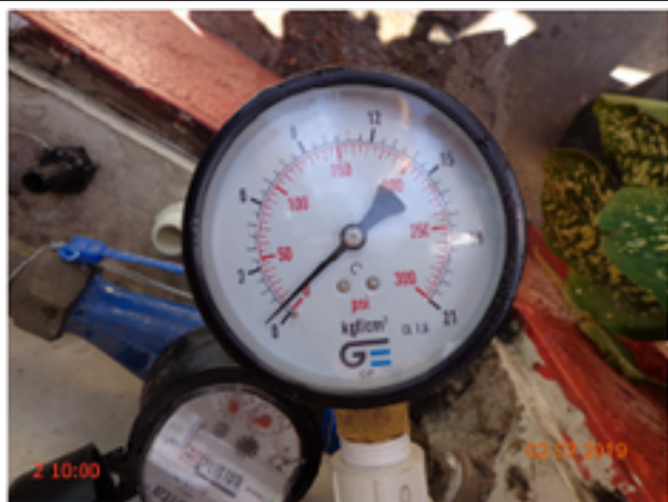
Foto 1 – RDA (Sede): pressão instantânea fora da faixa de 10 a 50 mca na R. Omar Paiva, nº 181.
