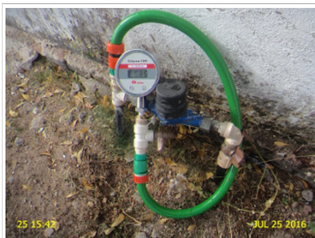
Foto 1 - RDA: medição instantânea de pressão no endereço localizado na Avenida Rafael de Abreu - Fórum.
