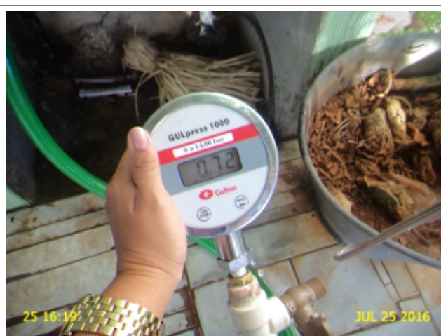
Foto 2 - RDA: medição instantânea de pressão no endereço localizado na Rua Assembléia de Deus, 20.
