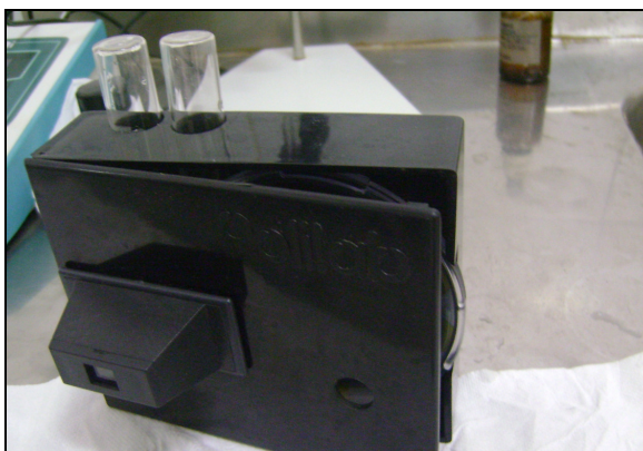
Foto 19 – Vista do Comparador de disco colorimétrico para cloro residual.
