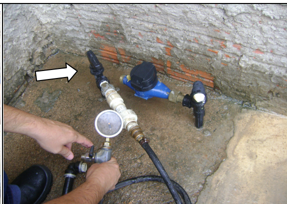
Foto 64 – Medição de pressão na Rua E, nº 140, Conjunto Pe. Joveniano, antes do hidrômetro.
