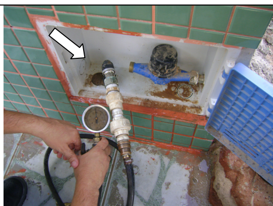
Foto 62 – Medição de pressão na Rua José Albuquerque, nº 184, Bairro Lagoa do Tigre Sul, antes do hidrômetro.
