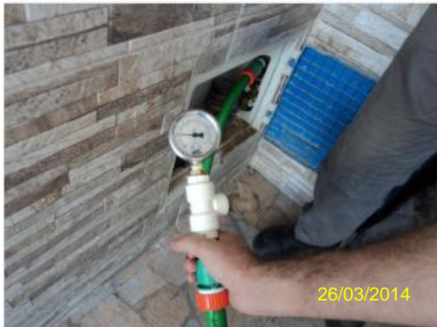
Foto 88 – RDA: medição instantânea de pressão na R. 115 de Novembro, nº 1038 – Bairro 15 de novembro.
