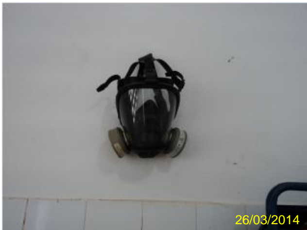
Foto 19 – Casa de química: máscara de cloro com filtro vencido e ausência de EPIs.
