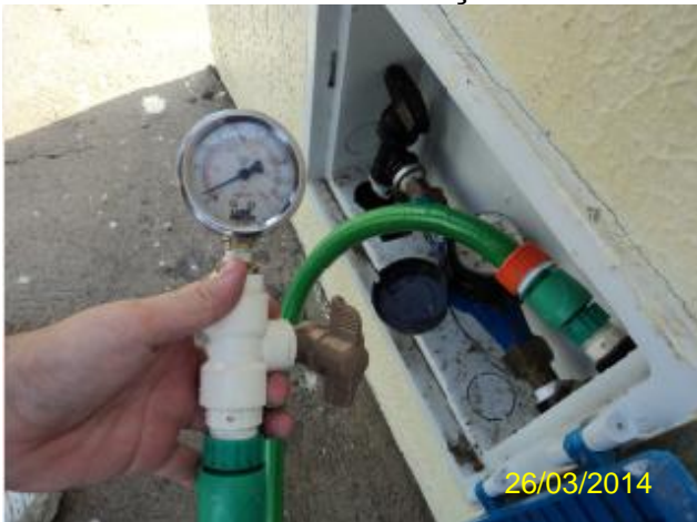
Foto 86 – RDA: medição instantânea de pressão na R. Presidente Juscelino, nº 202 – Bairro São Pedro.
