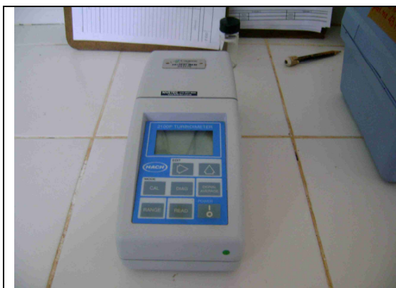
Foto 21 – Turbidímetro sem registros de calibração.
