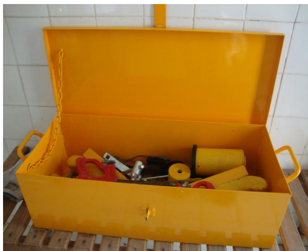
Foto 29 – Kit de emergência para cloro gasoso.
