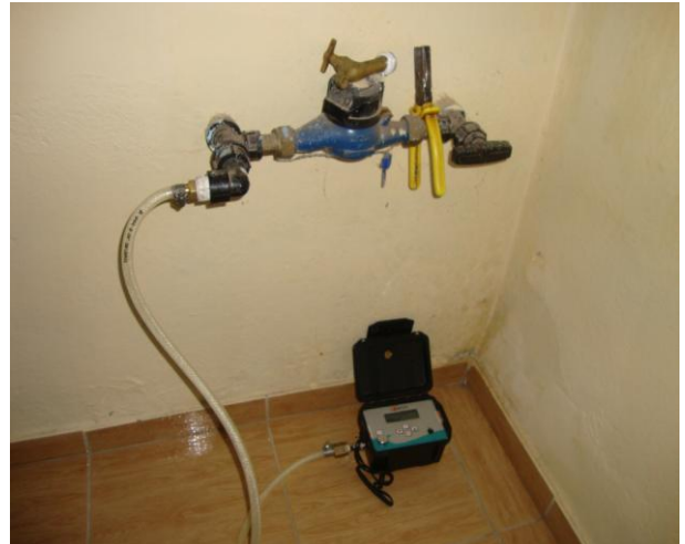
Foto 90 – Medição de pressão com instalação às 17:00h do dia 29/06/13 e retirada às 17:00h do dia 30/07/13, com aparelho datalogger na Rua D, nº 177, Bezerra de Sousa.
