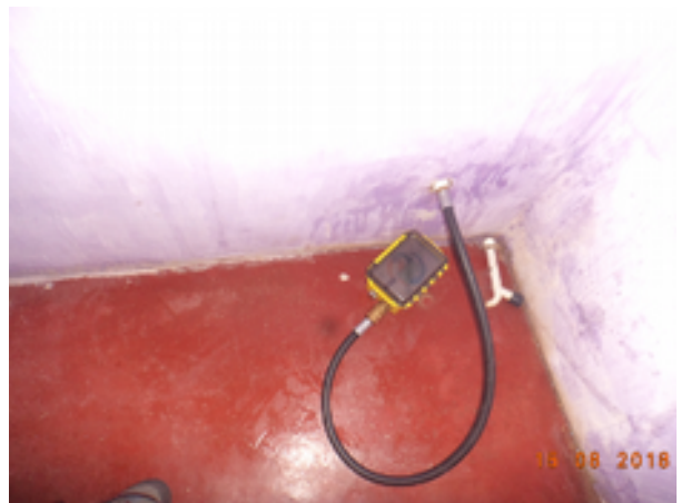
Foto 2 – RDA: medição contínua de pressão no endereço Rua Francisco das Chagas Nascimento, 508.
