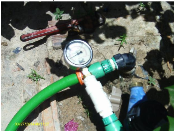
Foto 44 - Medição instantânea de pressão na rede de distribuição: Rua Irmã Diomira, SMS 5.
