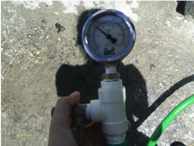
Foto 63 – Medição instantânea de pressão na Rua Raimundo Pontes Lima (Hospital).
