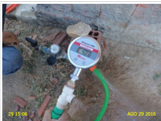
Foto 5 - Medição instantânea de pressão na rede de distribuição, no endereço localizado na Rua João Sapuruna, 822 (COELCE).
