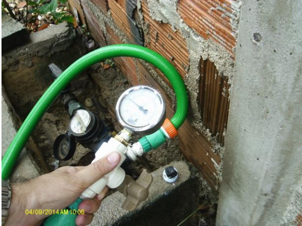
Foto 46 - Medição instantânea de pressão na rede de distribuição: Rua São Francisco, 155 - Aningas.
