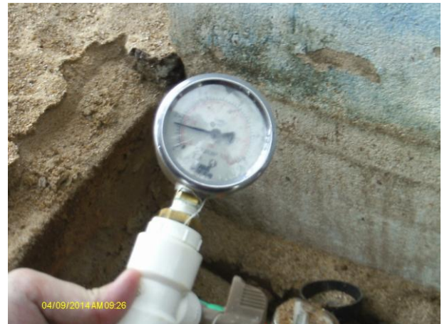
Foto 43 - Medição instantânea de pressão na rede de distribuição: Rua São Francisco, SMS 501.
