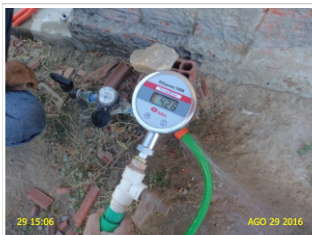
Foto 7 - Medição instantânea de pressão na rede de distribuição, no endereço localizado na Rua João Sapuruna, 822 (COELCE).
