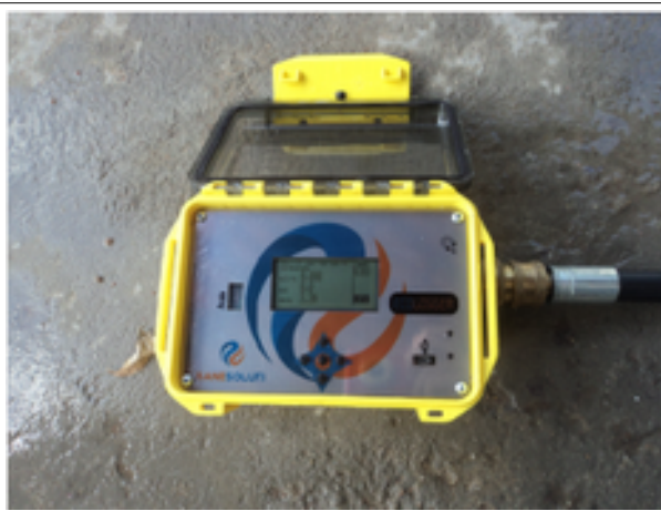
Foto 5 – RDA: medição instantânea de pressão na Rua Salvador, SMS 49.
