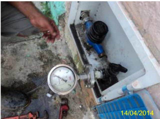
Foto 21 – RDA: medição instantânea de pressão na R. 13, s/n – Posto de Saúde Aparício Bezerra – Novo Maracanaú.
