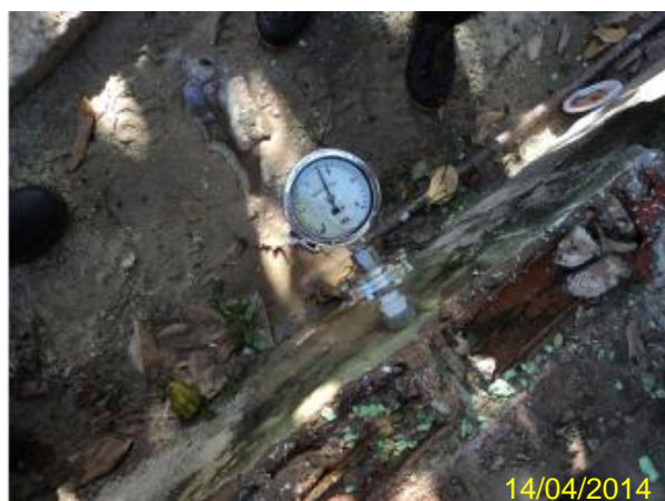
Foto 16 – RDA: medição instantânea de pressão na R. 20, nº30 – Unidade Básica de Saúde Santa Marta – Vila das Flores.
