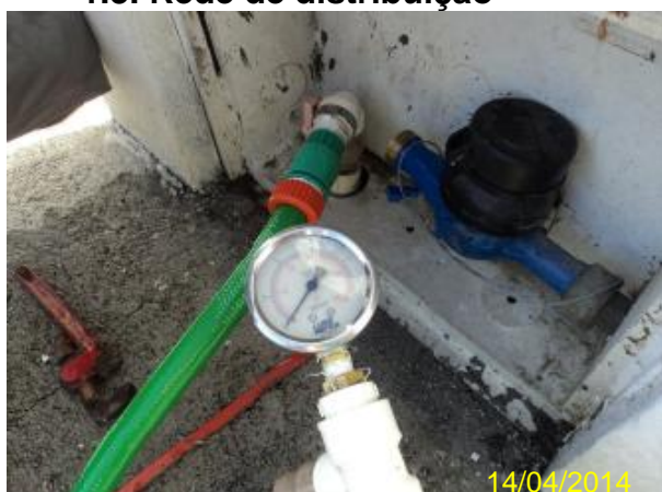
Foto 15 – RDA: medição instantânea de pressão na R. Gabriel Ferreira de Sousa, 51 – Olho D'Água.
