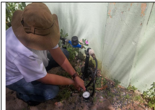
Foto 72 – RDA: medição de pressão no endereço Rua Capitão Miguel Lopes, 3 (SMS) – Córrego dos Reinaldos – EEIEF – Márcio Louzada.
