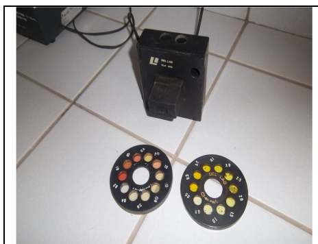
Foto 44 – Discos comparadores utilizados para a medição de cloro com valores adequados para a medição do teor residual.
