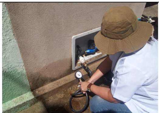
Foto 73 – RDA: medição de pressão no endereço Rua José Maria Louzada, 26 (SMS) - Amazonas.
