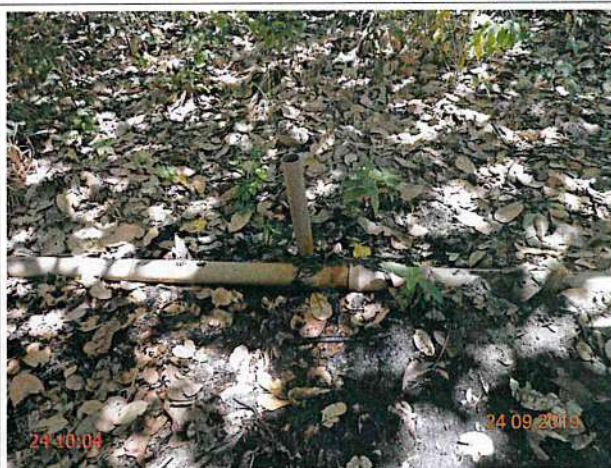
Foto 61 - PT-27 (Cumbe): vazamento na tubulação.
