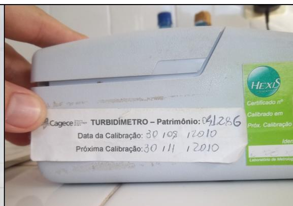
**Foto 30** – Registro da calibração do aparelho turbidímetro com data prevista para próxima calibração expirada.
