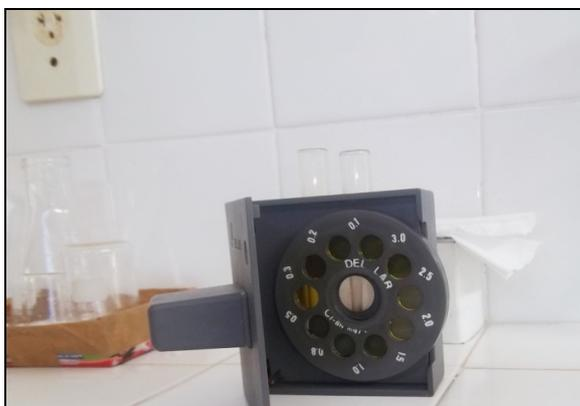
**Foto 29** – Disco comparador utilizado para a medição de cloro residual livre no laboratório da ETA.
