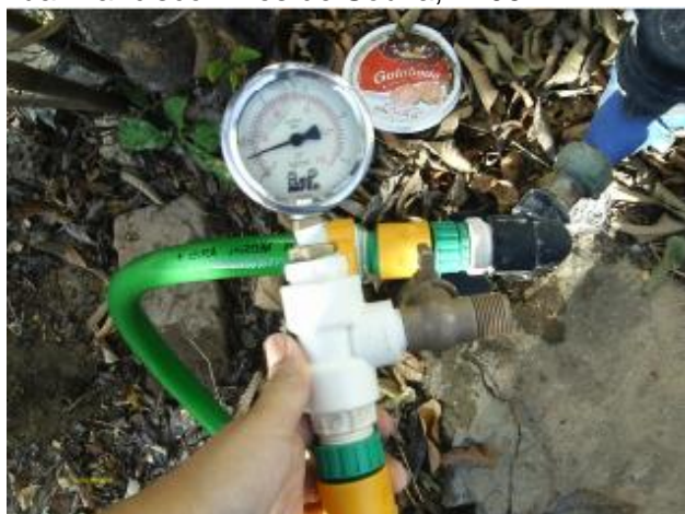
Foto 35 – Medição instantânea de pressão na Av. João Correia Dodó, 3 - Ocara.
