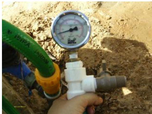
Foto 34 – Medição instantânea de pressão na Rua Gama, SMS 152 - Sereno.
