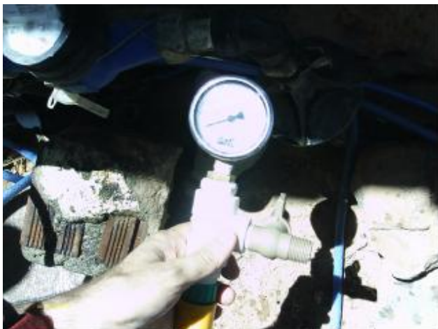
Foto 33 – Medição instantânea de pressão na Rua Francisco Alves de Souza, 2105.
