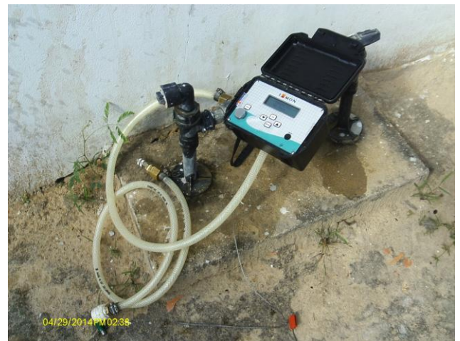
Foto 86 – Medição de pressão com instalação às 14:40h do dia 29/04/14 e retirada às 14:40h do dia 30/04/14, com aparelho datalogger no Sítio Vitorino (Igreja Cristã no Brasil).
