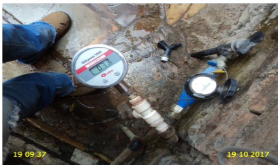
Foto 5 – RDA: medição de pressão instantânea na Estrada para o Crato, nº 780 – Terreiro Duro (2,6 mca).
