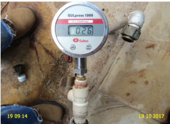
Foto 5 – RDA: medição de pressão instantânea na Estrada para o Crato, nº 780 – Terreiro Duro (2,6 mca).
