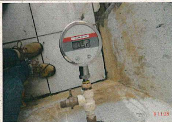
Foto 2 – RDA (Sede): pressão fora da faixa de 10 a 50 mca no endereço Rua Manoel Rufino, nº 541 – Piracicaba.
