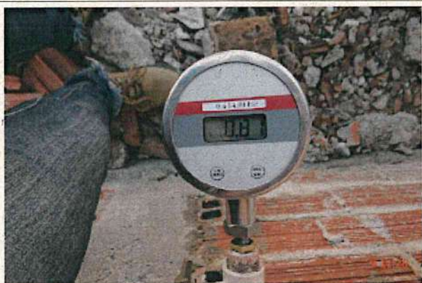
Foto 3 – RDA (Lisieux): pressão fora da faixa de 10 a 50 mca no endereço na Rua Olga Monte, s/n.
