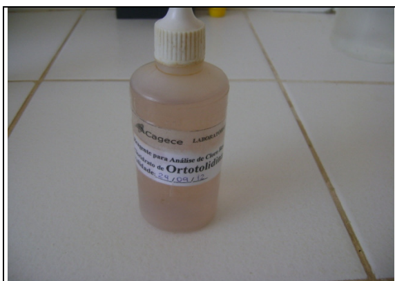
Foto 12 – Reagente químico Ortotolidina utilizado nas análises de cloro residual (dentro do prazo de validade – 29/9/2012).
