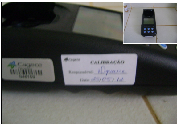
Foto 13 – Fotocolorímetro de análise do flúor, calibrado em 25/5/2012.
