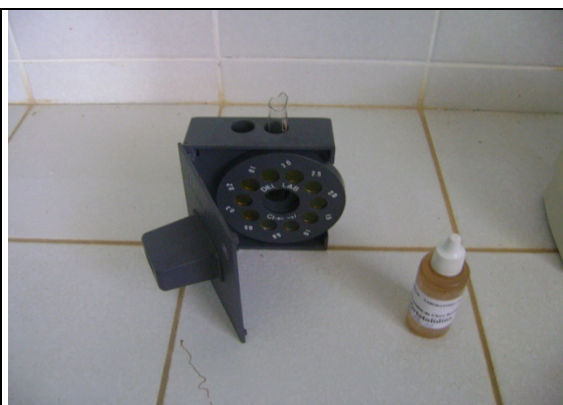
Foto 8 – Vista do Comparador de disco colorimétrico para cloro residual
