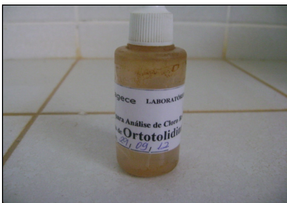
Foto 9 – Reagente químico Ortotolidina utilizado nas análises de cloro residual (dentro do prazo de validade – 29/9/2012).
