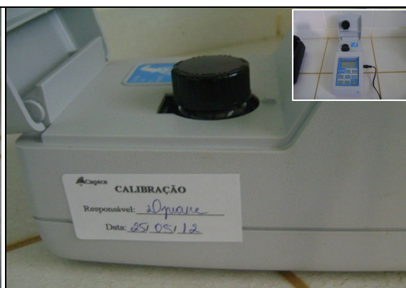
Foto 10 – Turbidímetro, calibrado em 25/5/2012.
