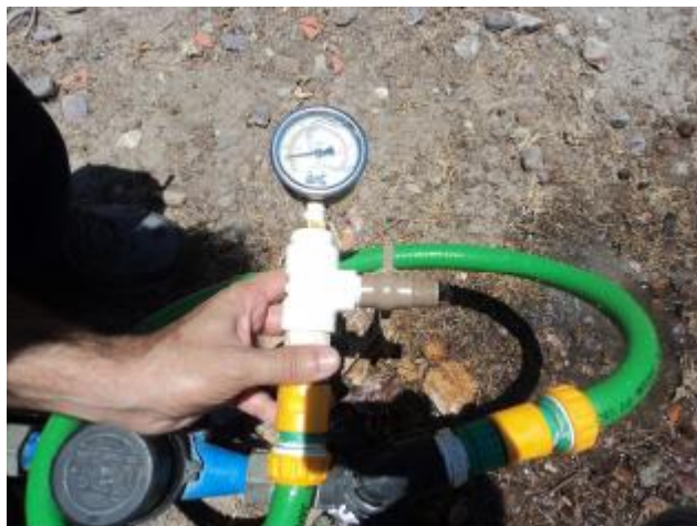
Foto 81 – Medição instantânea de pressão na Estrada da localidade de Passagem para Chaval (em frente ao REL-02)
