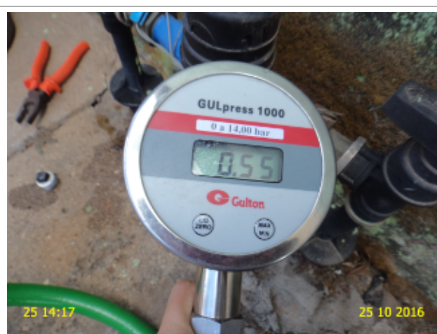
Foto 2 – Medição instantânea de pressão na rede de distribuição, no endereço localizado na Rua José Avelino (SMS-18) – São João.
