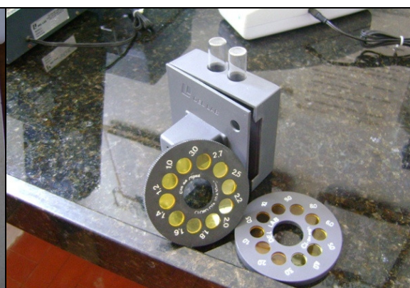
Foto 19 – Clorímetro e disco comparador.
