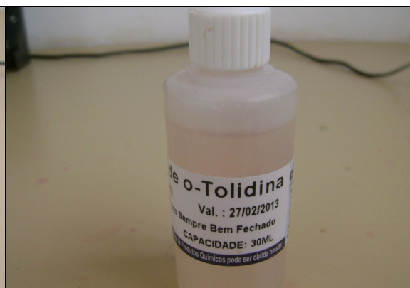
Foto 11 – Reagente químico Ortotolidina utilizado nas análises de cloro residual (dentro do prazo de validade – 27/2/2013).
