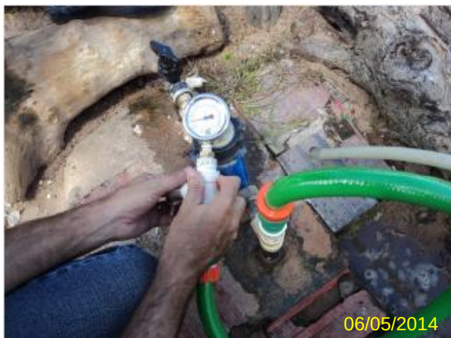
Foto 84 – RDA: medição instantânea de pressão na R. Alzira Gomes, 5.
