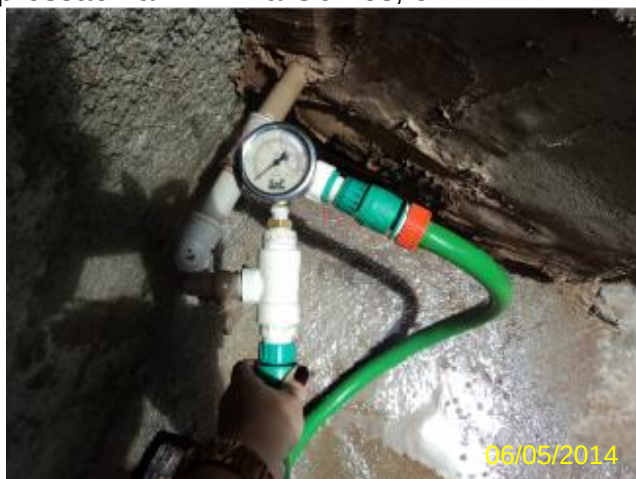
Foto 86 – RDA: medição instantânea de pressão na R. Manoel Antônio da Silva, 2483.
