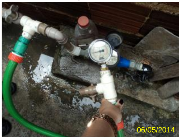
Foto 87 – RDA: medição instantânea de pressão na Av. Chanceler Edson Queiroz, 1866.
