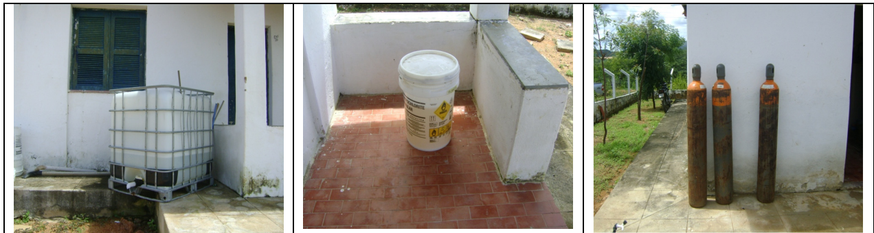
Fotos 10, 11 e 12 – Armazenamento inadequado de produtos químicos
