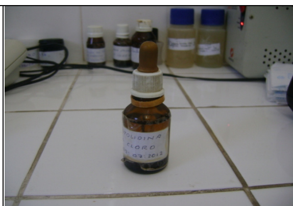
Foto 8 – Reagente químico Ortolidina utilizado nas análises de cloro residual (dentro do prazo de validade – 2/7/2012).
