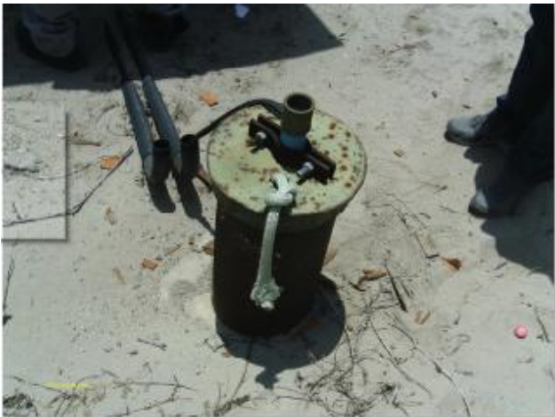
Foto 13 – PT-05 (desativado): proteção do poço.
