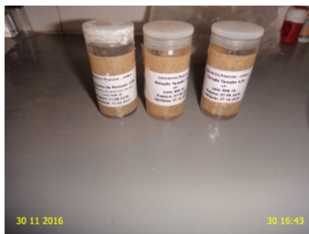
Foto 17 – Laboratório da ETA Caxitoré: solução tampão para análise de pH com data de validade vencida desde out/16.
