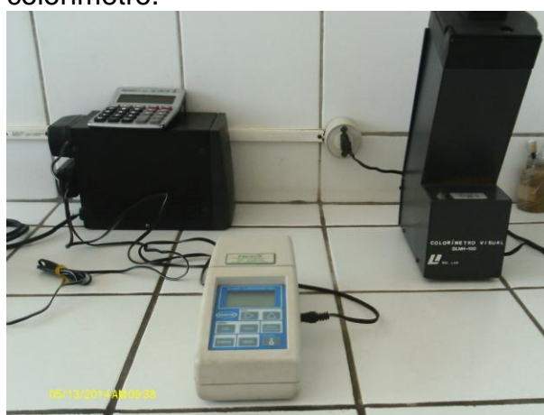
Foto 40 - ETA/Laboratório: equipamento turbidímetro.
