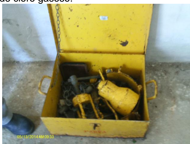
Foto 33 - ETA/Casa de química: Kit para emergências com cloro gasoso.
