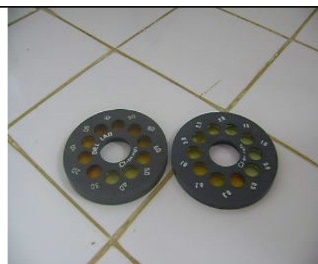
Foto 14 – Discos comparadores utilizados para a medição de cloro com valores adequados para a medição do teor residual.
