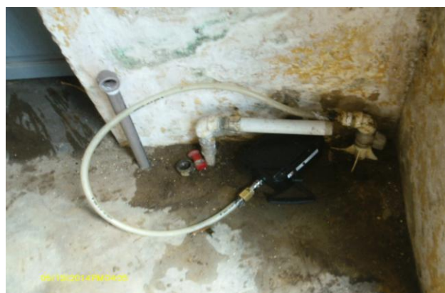
Foto 87 – Medição de pressão com instalação às 16:10h do dia 19/05/14 e retirada às 16:10h do dia 20/05/14, com aparelho datalogger na Av. Valdemar Rocha (FNS 11).
